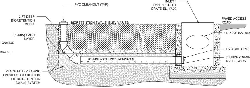
**CAPPED UNDERDRAIN DETAIL**
