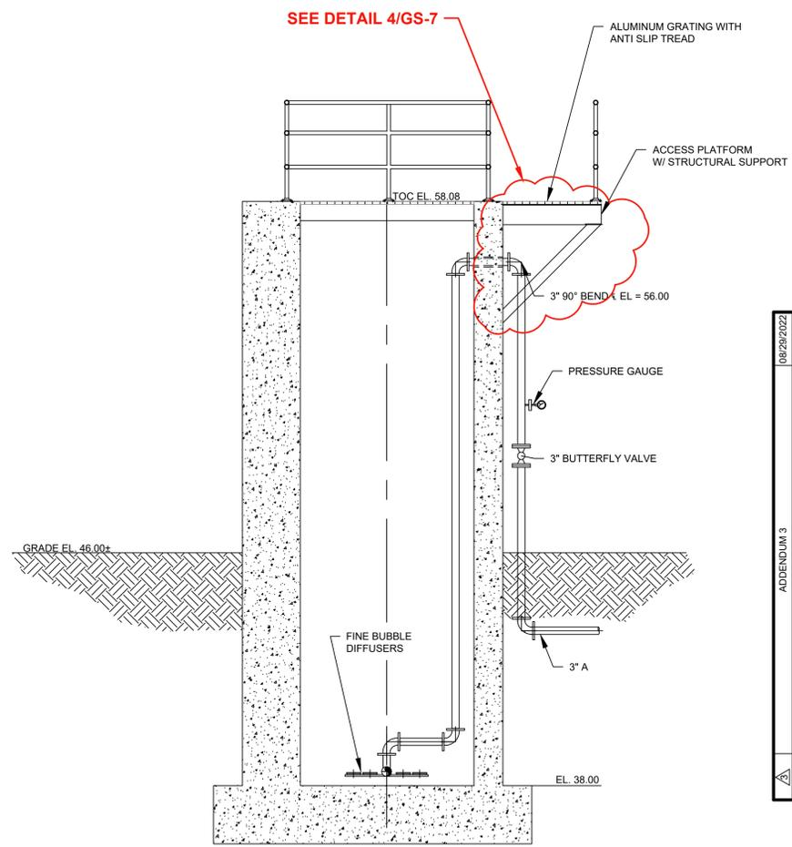
**EFFLUENT PUMP STATION SECTION B-B**
