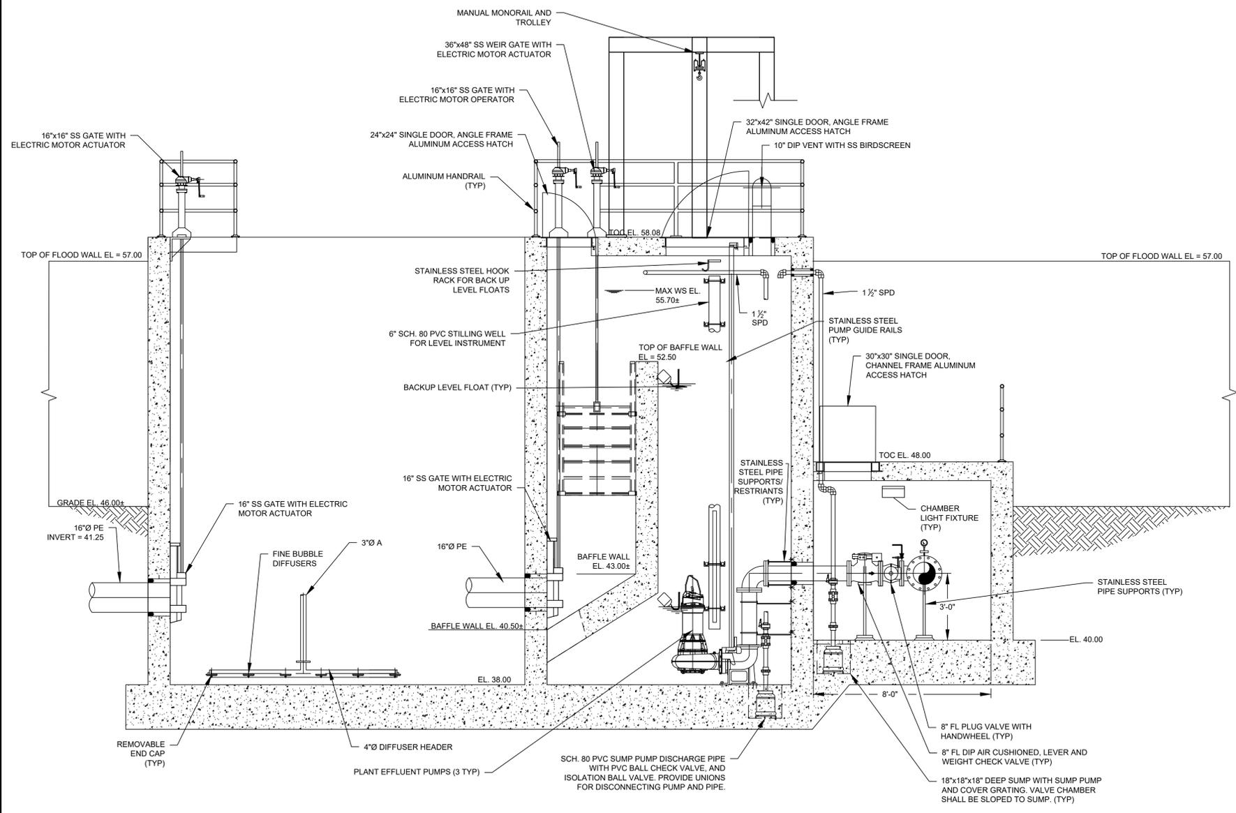
**EFFLUENT PUMP STATION SECTION A-A**
