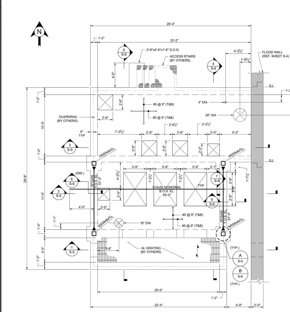
**STORM WATER PUMP STATION PLAN**
